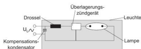
OPERATION OF HIGH INTENSITY DISCHARGE LAMPS WITH SEMI-PARALLEL IGNITION UNIT
